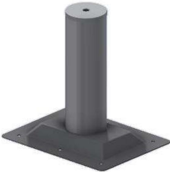
**Fonction :** Les potelets ECO-Flex permettent de maintenir en tension le câble de la ligne de vie et d'amortir le poids de l'utilisateur en cas de chute. Des essais sont réalisés conformément à la norme EN795 pour vérifier la résistance et le déclenchement des potelets en tant que point d'ancrage (type A) et ligne de vie (type C).
